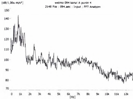
Rys.7. a) Analiza widmowa przekładni w zakresie częstotliwości 0-12kHz, b) Analiza widmowa przekładni: fz1.fz2 częstotliwości ząbzeń
