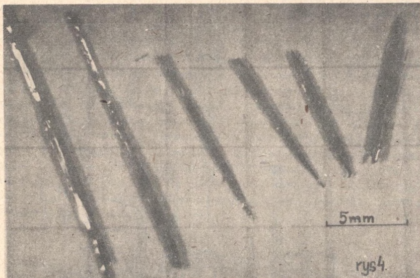
Rys. 4. Monokryształy SbSI uzyskane przy zastosowaniu metody odwracalnego gradientu temperatury
