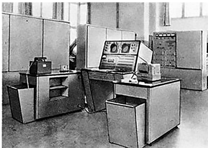
Fotografia 10. ZAM-2 – udoskonalona wersja komputera XYZ: stanowisko operatora z pulpitem o dwóch oscyloskopach (bardzo podobnym do monitora XYZ), po obu stronach perforator i czytnik taśmy papierowej, jednostka centralna w dwóch szafach po lewej, zasilanie w szafie po prawej (1961)
