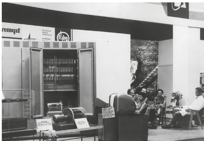
Fotografia 20. UMC-1 na wystawie w Moskwie prezentuje się już znacznie lepiej. Zgodnie z zasadami ówczesnego PR na pierwszym planie wyeksponowano pamięć bębnową oraz rozluźnionego naukowca w białym fartuchu, a w tle – górniką fedrującego bazę danych
