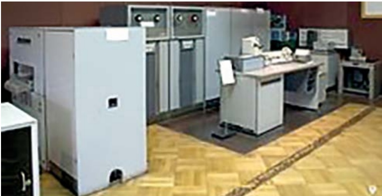
Fotografia 14. ZAM-21 w warszawskim Muzeum Techniki; mniej więcej pośrodku widać dwie stacje pamięci taśmowej PT-2, które wyglądają jak przerośnięte magnetofony szpulowe
