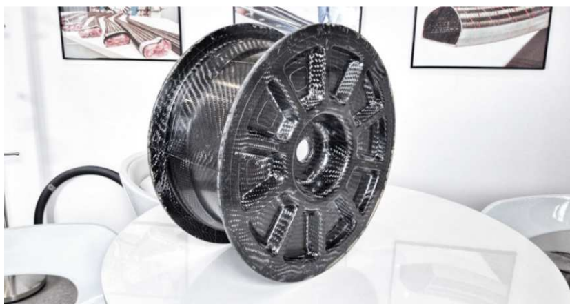
Rys. 2.3. Felga z kompozytu CFRP wykonana przez polską firmę Fibratex [15]
