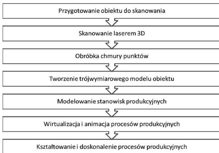
Rysunek XII.2. Etapy poprzedzające kształtowanie procesu na drodze wirtualizacji produkcji Źródło: opracowanie własne.
