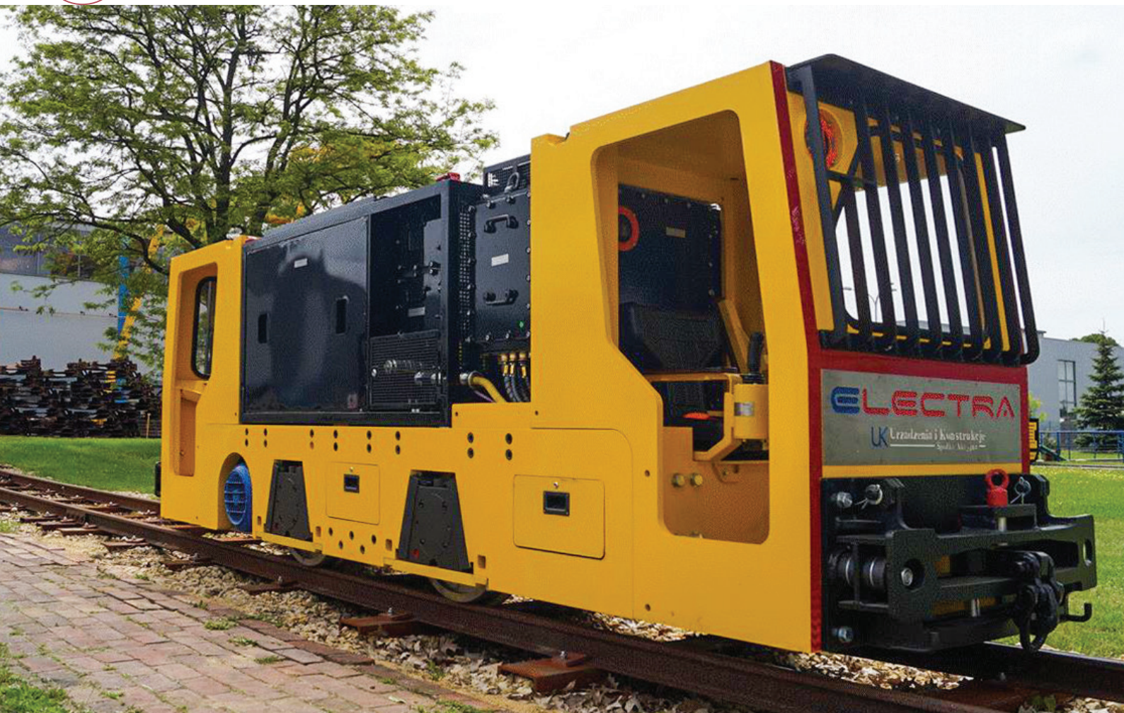
Elektryczna Lokomotywa Akumulatorowa „Electra” ze zmiennym rozstawem kół. / fot. mat. konferencyjne
