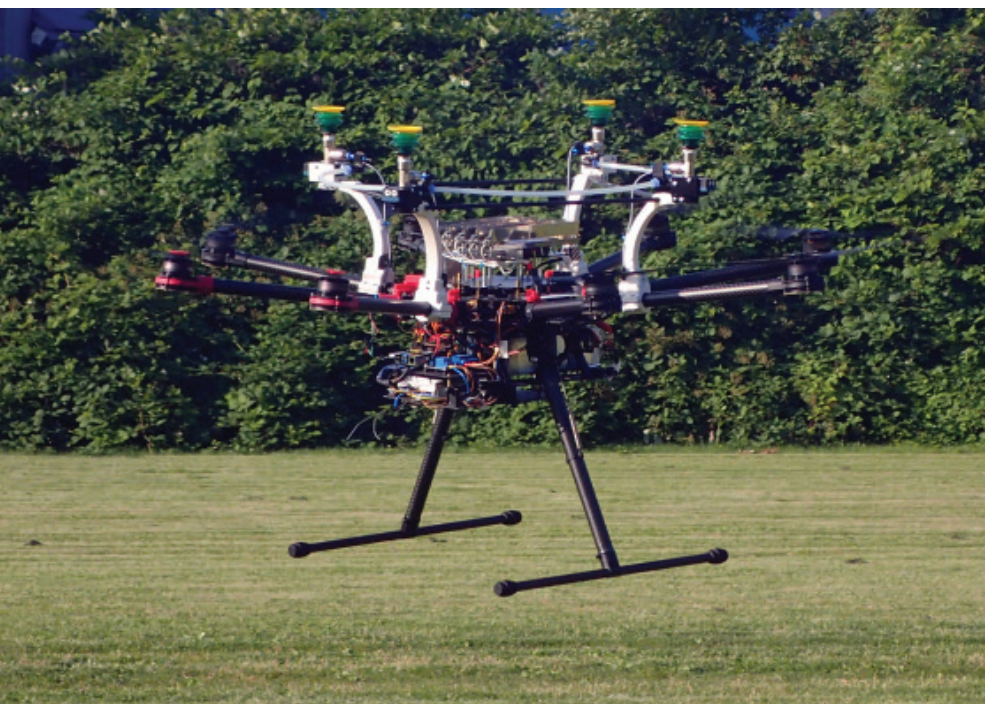
Bezzałogowa platforma latająca do diagnostyki konstrukcji budowlanych / fot. mat. konferencyjne
