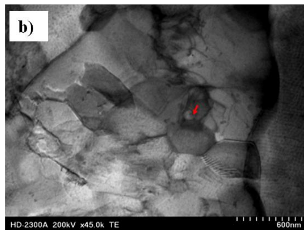
Rys. 60.a-b) Mikrostruktura stopu Al-25%Cu po wyciskaniu KoBo przy stopniu przerobu \lambda=98
