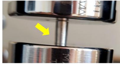
Rys.24. Przykładowy obraz próbki przygotowanej do przeprowadzenia statycznej próby ściskania
