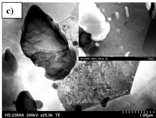
Rys. 59.a-c) Mikrostruktura stopu Al-25%Cu po wyciskaniu KoBo przy stopniu przerobu \lambda=30
