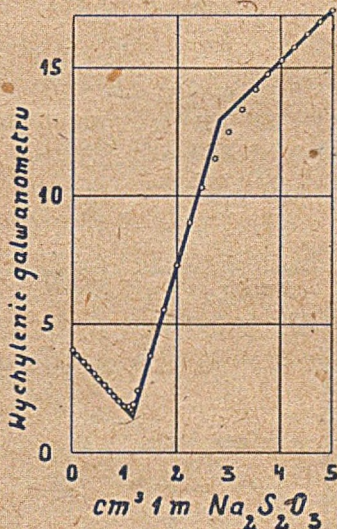
Rys. 3. Miareczkowanie konduktometryczne 2,5 cm 3 1 m TlNO 3 roztworem 1 m Na 2 S 2 O 3 w 20° C. Conductometric titration of 2,5 cm 3 1 m TlNO 3 with 1 m Na 2 S 2 O 3 at 20° C.
