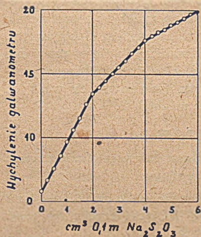
Rys. 1. Miareczkowanie konduktometryczne 2\text{ cm}^3 0,1\text{ m} TlNO_3 roztworem 0,1\text{ m} Na_2S_2O_3 w 20^\circ .
