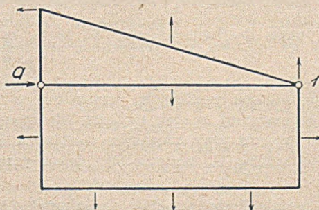
Rys. 53. Sieć elektryczna o jednym punkcie węzłowym.
