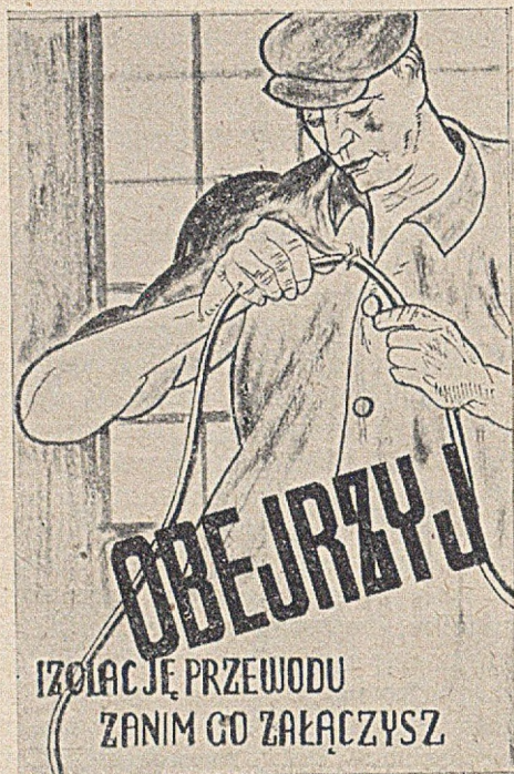
Rys. 4. Robotnik sprawdza stan izolacji przewodu gładkiego, gdyż tego rodzaju przewody są najbardziej narażone na uszkodzenia mechaniczne.
