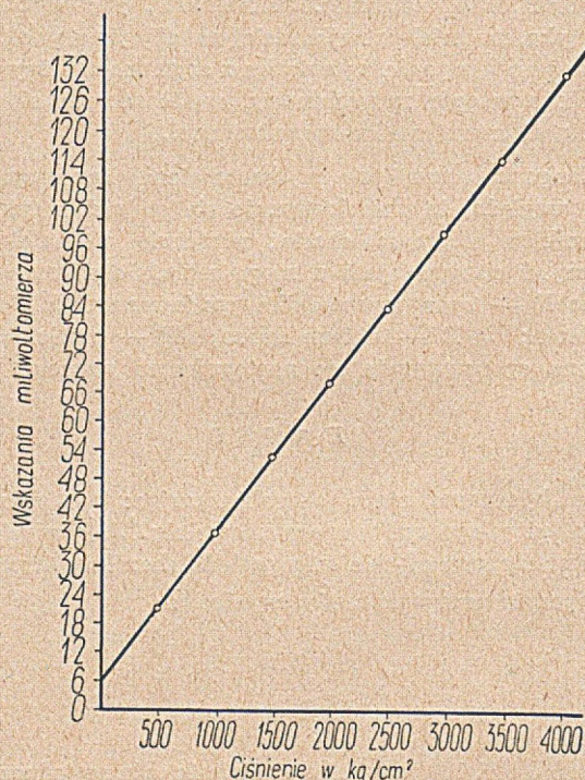
Rys. 3. Charakterystyka manometru manganinowego, obrazująca zależność wskazań miliwoltomierza od ciśnienia.
