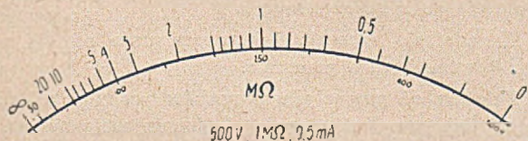
Rys. 6. Charakter podziałki omomierza indukcyjnego.
