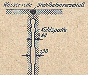
Abb. 13. Ausbildung einer Kühlepalte (Tölkke: Wasserkraftanlagen Berlin 1938, S. 297).
