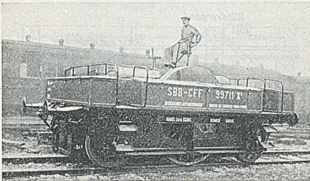
Abb. 1. Brückenbelastungswagen. Ansicht (betriebsbereit).
