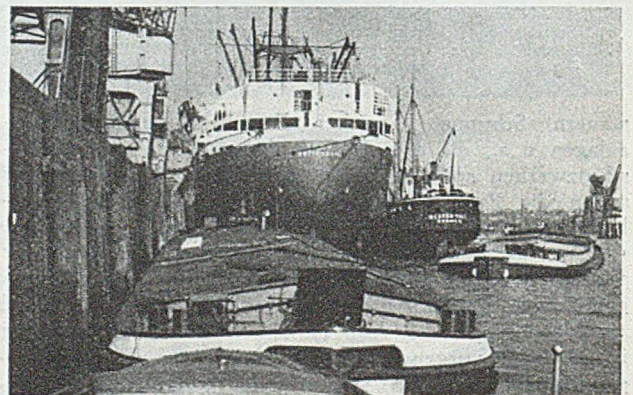
Abb. 4. Ein großer Seedampfer lädt gleichzeitig zum Kai und in einen Küstendampfer (kombinierter Kai- und Strombetrieb).
