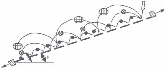
Rys.3. Ruch ziaren na sicie drgającym w cienkiej warstwie Fig. 3. The motion of particles in a thin layer on a vibrating screen
