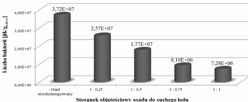
Rys. 3.2. Ogólna liczba bakterii (jtk) w 1 g osadu nadmiernego przed i po procesie higienizacji suchym lodem.
