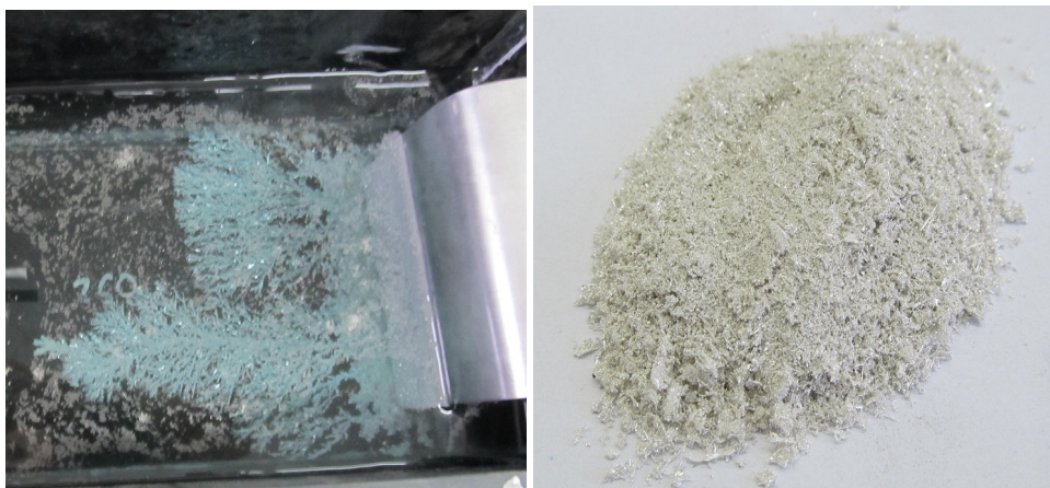
Rys. 3.2.2. Srebro o czystości 99,95% otrzymane w wyniku procesu elektrorefinacji. Po prawej stronie kryształy srebra wydzielone na katodzie; po lewej stronie srebro wyciągnięte z elektrolizera
