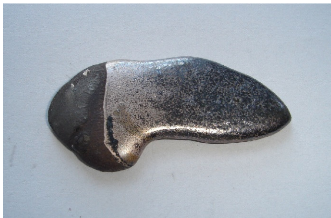
Rys.3.1.2. Srebro wytopione w procesie pirometalurgicznym
