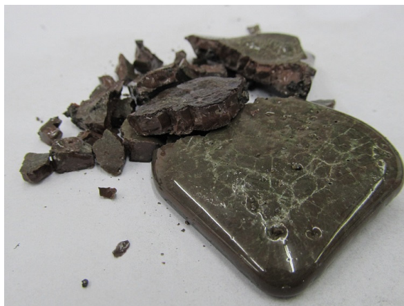
Rys. 3.1.3. Zdjęcie żużlu po procesie pirometalurgicznym
