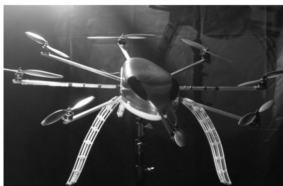
Rys. 1.2. RoboKopter – UAV wykonujący z powietrza zdjęcia lotnicze i filmy w jakości full HD (źródło: archiwum własne autora).
