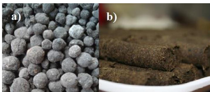
Rys. 4.1 Próbki biomasy: a) osad ściekowy, b) algi
