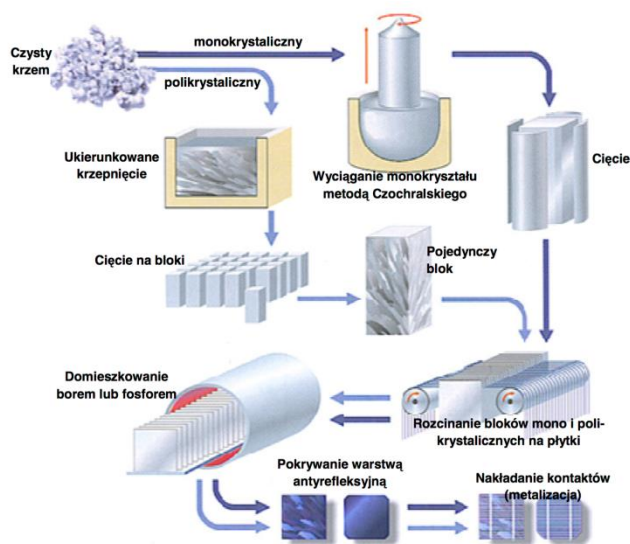
Rys. 1.3 Wytwarzanie mono i polikrystalicznych krzemowych ogniw fotowoltaicznych [1].
