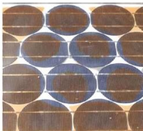
Rys. 1.5 Zniszczona warstwa EVA w obszarze modułu fotowoltaicznego [12].
