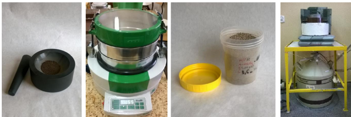
Rys 3 Kolejne etapy przygotowania próbki do pomiarów radiometrycznych – rozdrabnianie, przesiewanie, próbka gotowa do pomiaru, pomiar na spektrometrze gamma.
