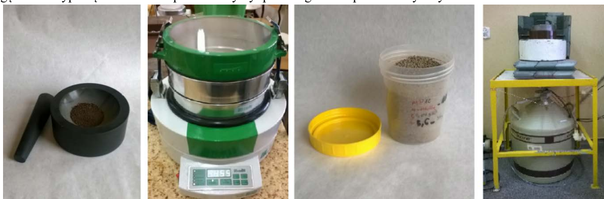
Rys. 2.2. Etapy procesu przygotowania próbek gleby do pomiarów radiometrycznych.
