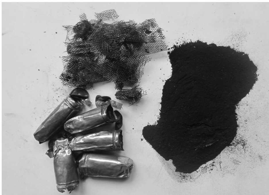
Rys. 11. Frakcje materiałowe uzyskane po zakończeniu separacji
