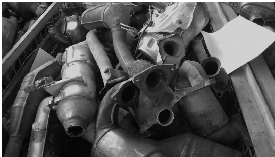
Rys. 4 Odpady z demontażu pojazdów zawierające metale szlachetne (fot. M.Chyc)
