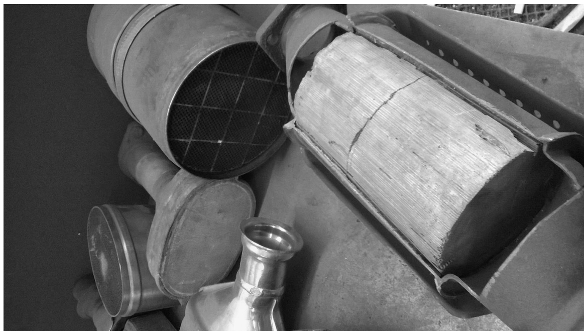
Rys. 1 Układy katalityczne stosowane w samochodowych systemach oczyszczania spalin (fot. M.Chyc)
