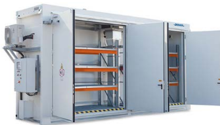
Rys. 2.3 Magazyn regałowy RFP do przechowywania baterii wtórnych litowo-jonowych- ochrona przeciwpożarowa do 120 min (REI 120) od środka i z zewnątrz. [17]
