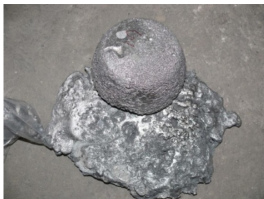
Rys. 3.9 Stop kobaltowy z próby przetopu frakcji elektrodowej BWLJ klasa ziarnowa &lt; 1 mm -próba 2
