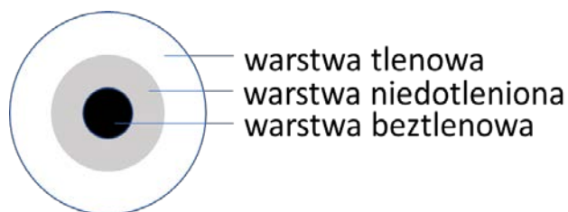
Rys. 2.2. Wielowarstwowa struktura granul tlenowej
