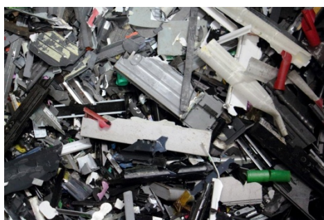
Rys. 3.2A) Frakcja tworzywowa z baterii wtórnych litowo-jonowych typu LCO
