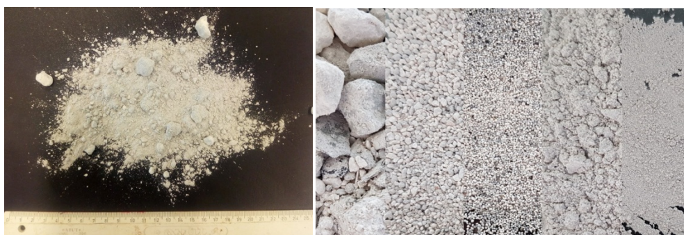
Rys. 4.1. Pył z Instalacji Termicznego Przekształcania Odpadów Komunalnych
