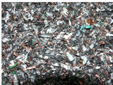
Rys. 3.4C) Frakcja Cu/Al. z baterii wtórnych litowo-jonowych typu LCO
