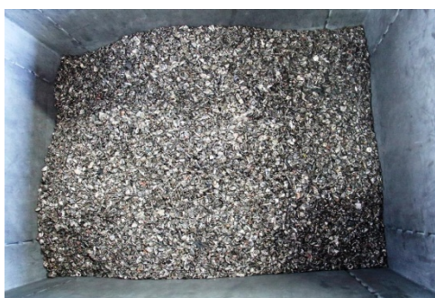
Rys. 3.3B) Frakcja stalowa z baterii wtórnych litowo-jonowych typu LCO
