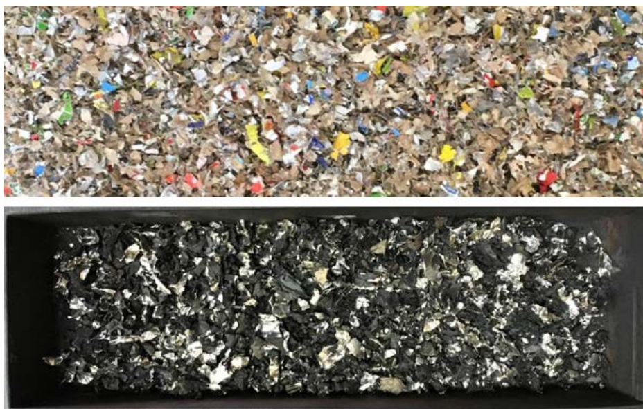
Rys. 3. Zdjęcie materiału przed i po procesie pirolizy.
