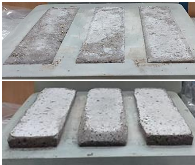
Rys. 5.1. Geopolimer nr 1 (pęczniejący) oraz 2 (bez pęcznienia) po 28 dniowym okresie dojrzewania.
