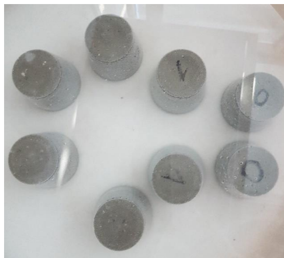
Rys. 3.2. Zaprawa cementowa, a) w dniu rozformowania, b) w czasie dojrzewania (wyk. M. Czop).
