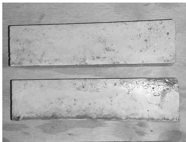
Rys. 5.2. Zaprawa cementowa i geopolimer z aktywowanym alkalicznie żużlem z ITPOK
