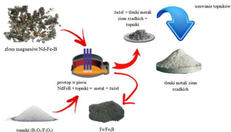
Rys. 3.2. Schemat recyklingu magnezów Nd-Fe-B w procesie utleniania [10]
