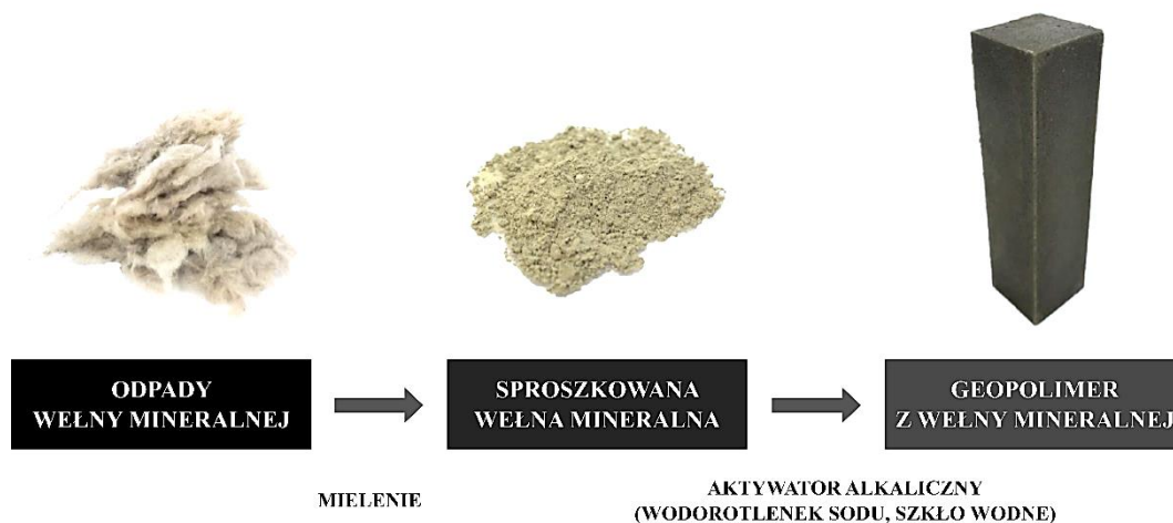
Rys. 3.3. Schemat wytwarzania geopolimeru z wełny mineralnej (na podstawie – [23]).
