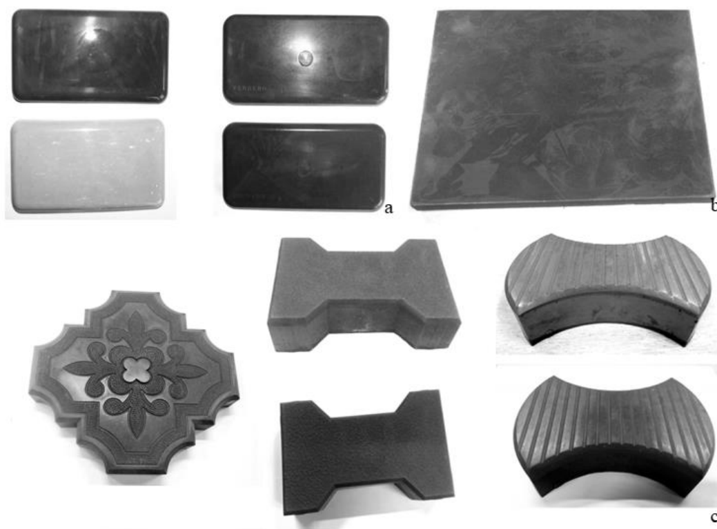
Rys. 1.4. Wyroby z geopolimeru: a) płytki o różnych barwach; b) płytką imitującą płytkę ceramiczną; c) kostka brukowa o różnych kształtach; [3]
