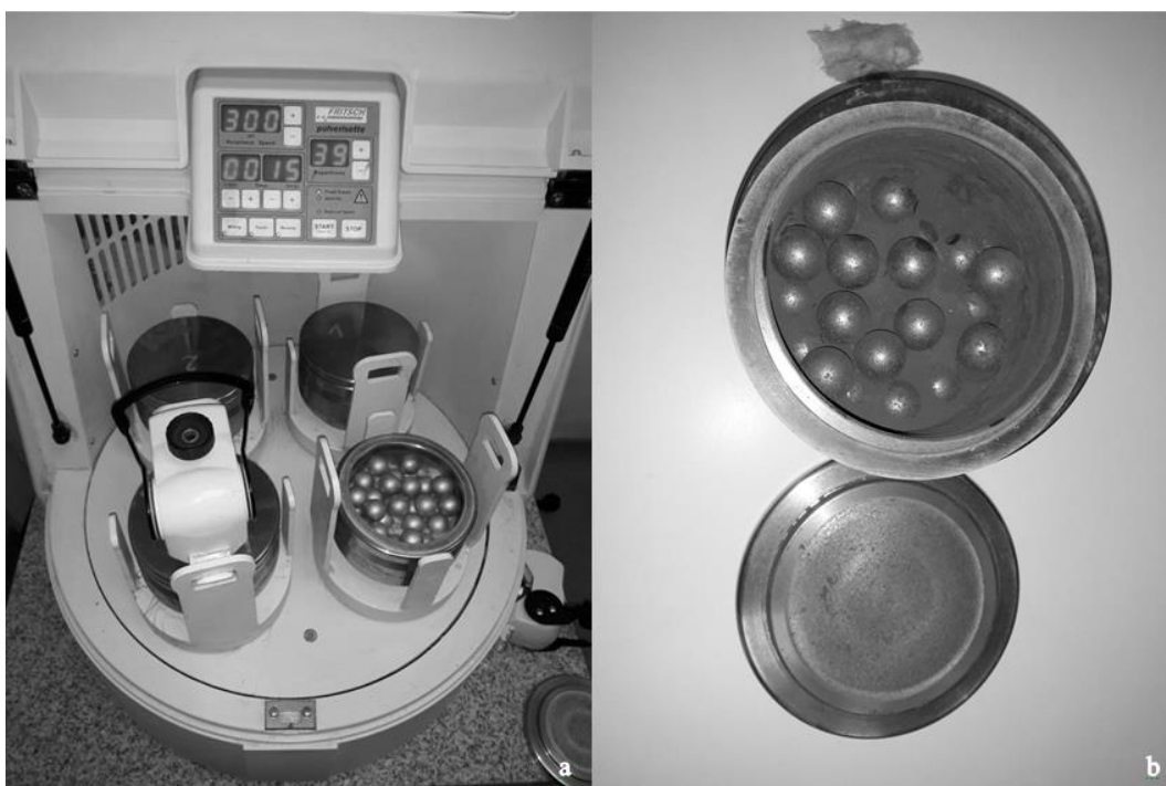
Rys. 4.3. a) Planetarny młynek kulkowy 4-stanowiskowy Pulverisette 5 firmy Fritsch przygotowany do procesu mielenia; b) zmielona wełna szklana w mielniku (wyk. własne)
