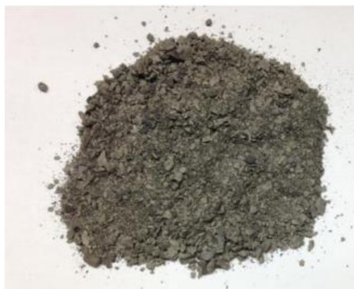
Rys. 3.11. Magnes neodymowy po dezintegracji metodą HD [20].
