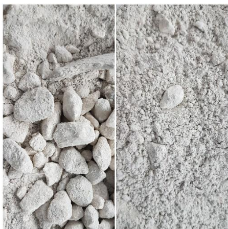
Rys. 3.1. Materiały użyte do badań, a) odpady z oczyszczania gazów odlotowych, b) cement portlandzki – CEM I (wyk. M. Czop).
