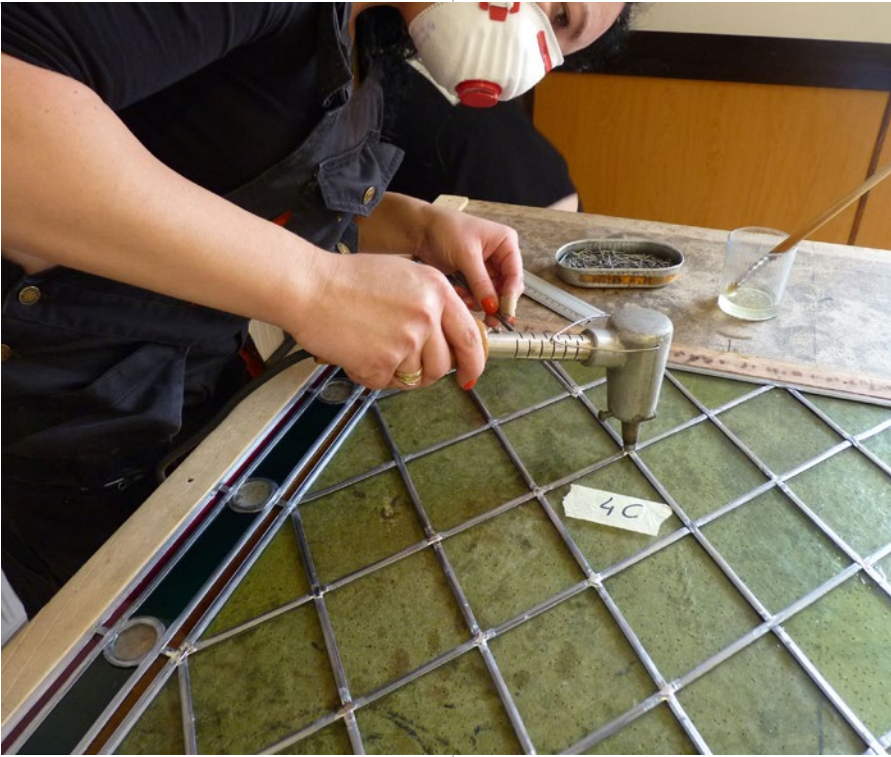
Ryc. 70, 71. Lutowanie profili ołowianych
