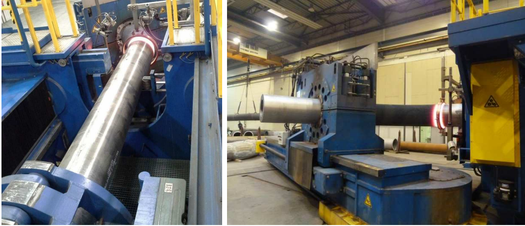
Rys. 3.1. Widok stanowiska firmy Cojafex do gięcia rur z lokalnym nagrzewaniem indukcyjnym
