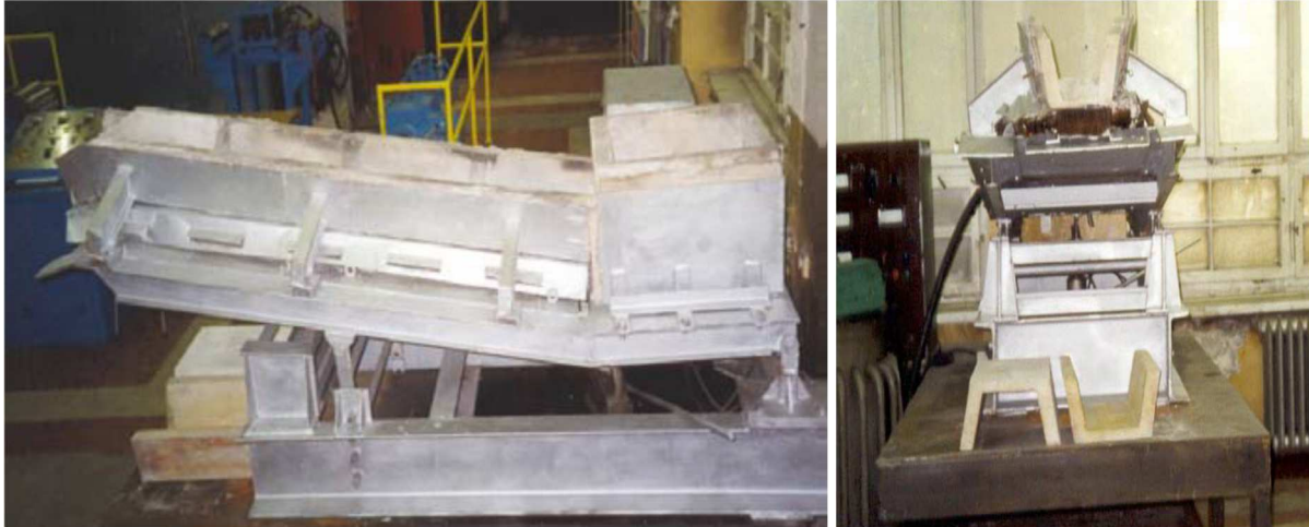
Rys. 1.3. Widok rynny elektromagnetycznej na stanowisku doświadczalnym: widok z boku oraz widok z przodu, przed rynną kształtki ceramiczne
