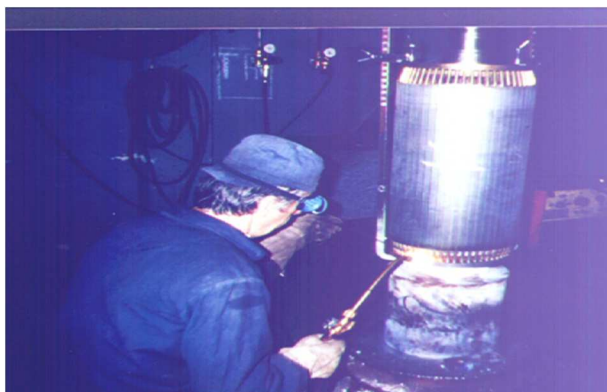
Rys. 2.17. Uzwojenie lutowane gazowo
