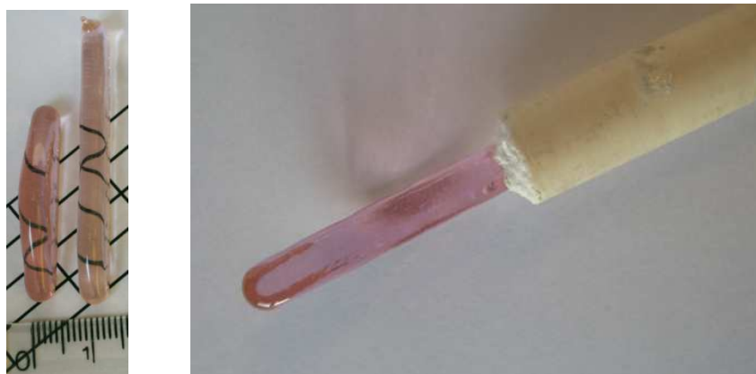
Rys. 6.5. Widok preform ze szkła tlenofluorkowego przygotowanych do wyciągania włókien
