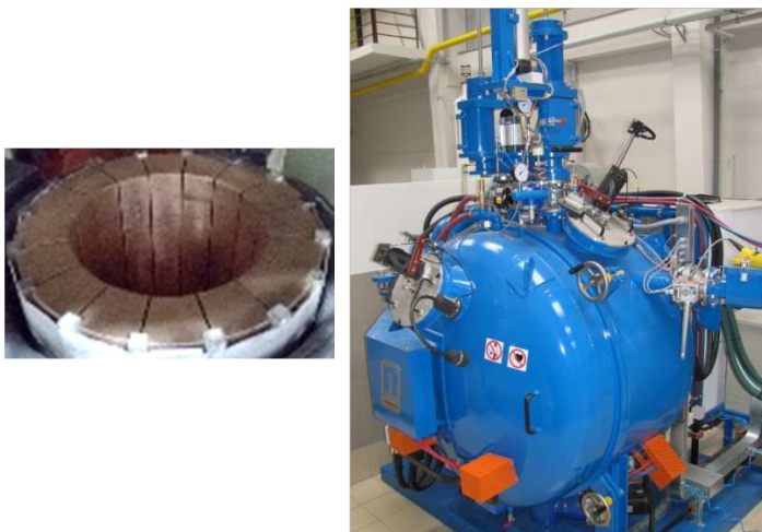
Rys. 1.13. Indukcyjny piec próżniowy VIM ISM Lab 2-200 z zimnym tygłem miedzianym.
