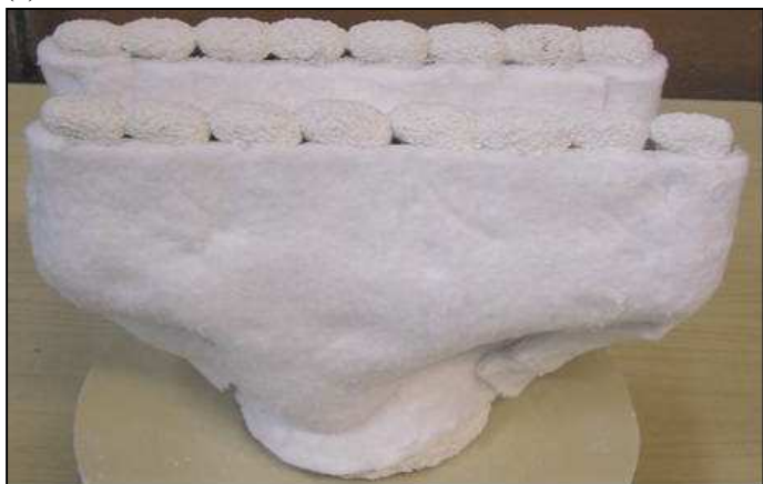
Rys. 3.6. Etapy odlewania precyzyjnego łopatek: a) model woskowy, b) zestaw modelowy do wykonania wielowarstwowej formy ceramicznej wraz z układem wlewowym, c) wielowarstwowa forma ceramiczna, d) gotowe odlewy
