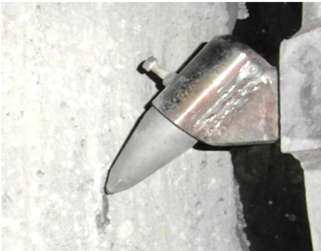
Rys. 4.11. Nóż styczno-obrotowy przygotowany do badań [11]
