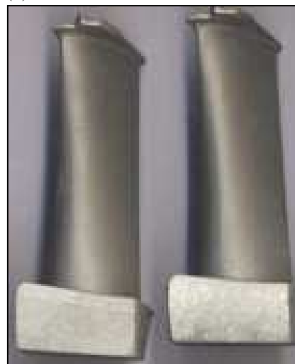
Rys. 3.6. Etapy odlewania precyzyjnego łopatek: a) model woskowy, b) zestaw modelowy do wykonania wielowarstwowej formy ceramicznej wraz z układem wlewowym, c) wielowarstwowa forma ceramiczna, d) gotowe odlewy
