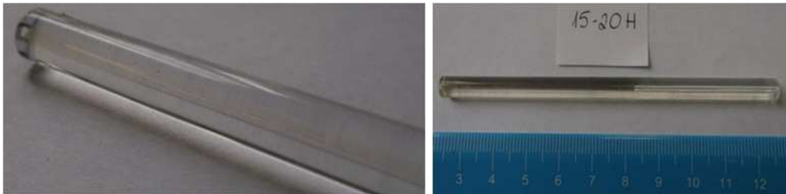
Rys. 6.13. Włókno ze szkło-ceramiką tlenofluorkową w otulinie zmodyfikowanego polimeru PMMA
