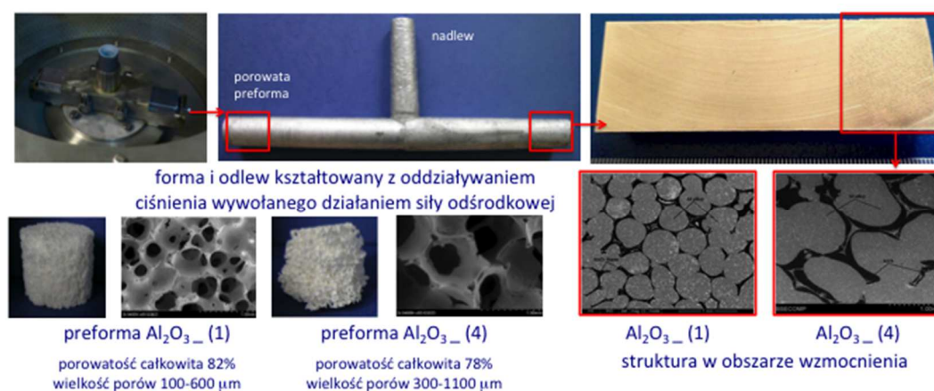
Rys. 8.10. Widok formy, odlewu i przykłady struktury w obszarze wzmocnionym preformą ceramiczną
