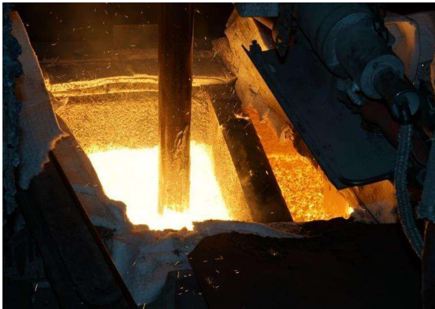
Rys. 6.7. Wygrzana kadź pośrednia z zabudowanym filtrem ceramicznym
