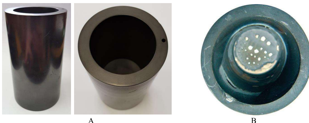
Rys. 3.3. Tygle CHIP przed procesem wytapiania (A) i po pierwszym wytopie (B)
