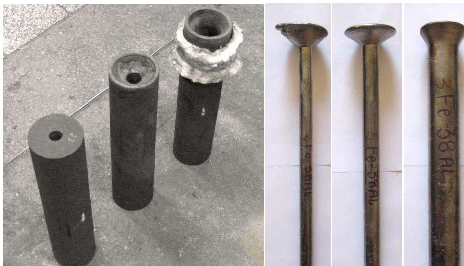
Rys. 2.2. Przykładowe wlewki ze stopów Fe-Al odlane do form grafitowych [6]
