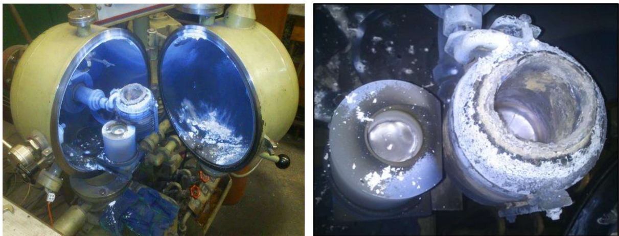
Rys. 3.5. Wygląd komory pieca po wytapianiu stopu Mg-7,5Li w próżni
