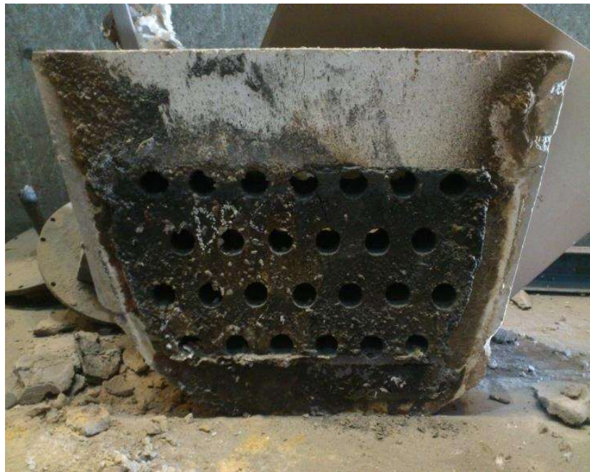
Rys. 6.8. Wielootworowy filtr ceramiczny po zakończeniu odlewania na MCOS-2
