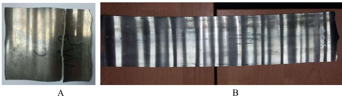
Rys. 2.12. Płytkę ze stopu typu Ni-Al-B zanieczyszczonego siarką, pękniętą podczas walcowania (A); Taśma uzyskana ze stopu Ni-Al-B o wymaganej czystości i strukturze (B)
