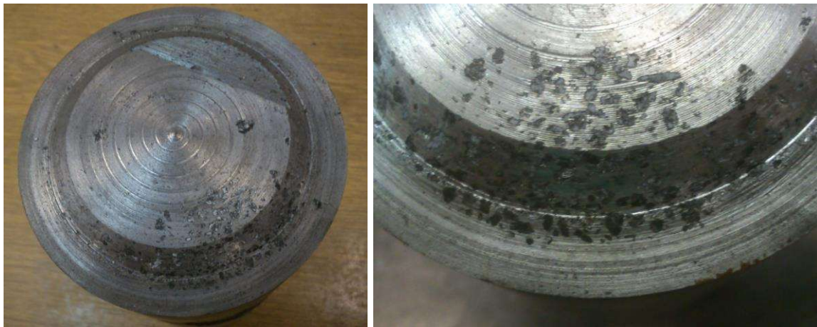
Rys. 3.6. Cząstki masy ceramicznej, oderwane z wymurówki ogniotrwałej i zalegające w dolnej części wlewka ze stopu LAZ431
