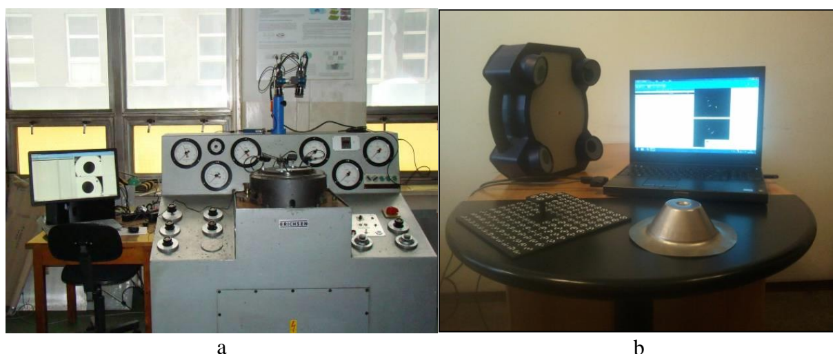
Rys. 6.2. Fotografia: a) stacjonarnego, b) przenośnego systemu pomiarowego do analizy odkształceń lokalnych AutoGrid firmy Vialux, zabudowanego na uniwersalnej prasie hydraulicznej Erichsen model 145-60 w laboratorium badań tłoczności
