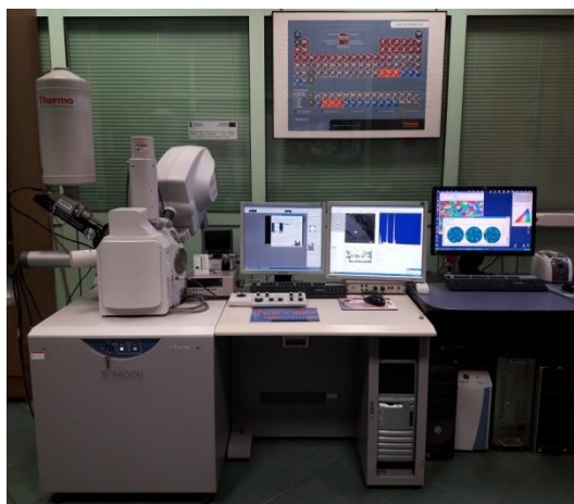
Rys. 3.1. Elektronowy mikroskop skaningowy Hitachi S-3400N wyposażony w system INCA HKL Nordlys II (Channel 5)
