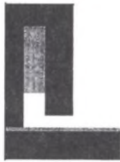
Rys.2. Fragment przekroju modelu indukcyjnego przetwornika grubości powłoki Fig. 2. Fragment of the cross-section of a coating thickness inductive transducer
