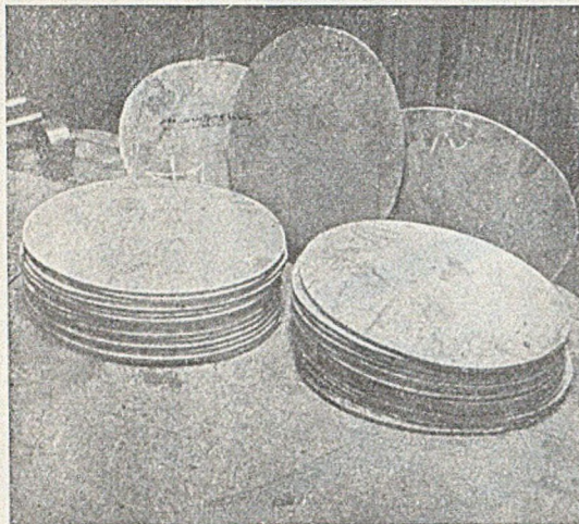
Rys. 71. Tarcze grub. 12 mm. Długość cięcia 1 tarczy - 1,65 m. Czas - 7 m.
