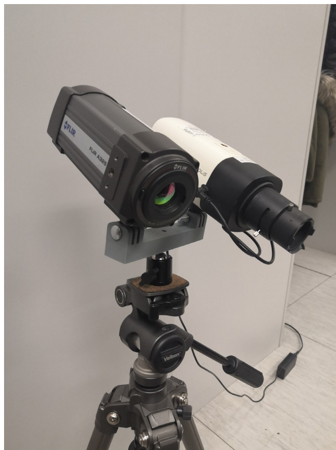
Rys. 1. Termowizyjno-wizyjne stanowisko badawcze. Źródło: opracowanie własne.
