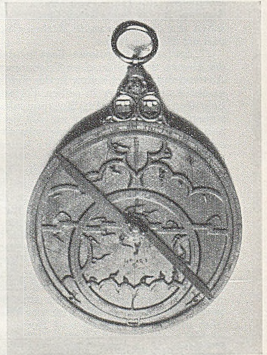
Abb. 5. Ein Astrolabium des Regiomontanus. Der Apparat wurde zu Höhenmessungen am Himmel benutzt. Er besaß eine drehbare Scheibe.
