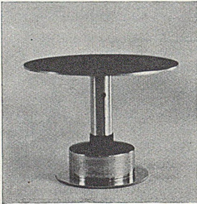
Abb. 1. Der Zusatzstisch, eingeschoben in die Zylinderblende eines normalen Mikroskops.
