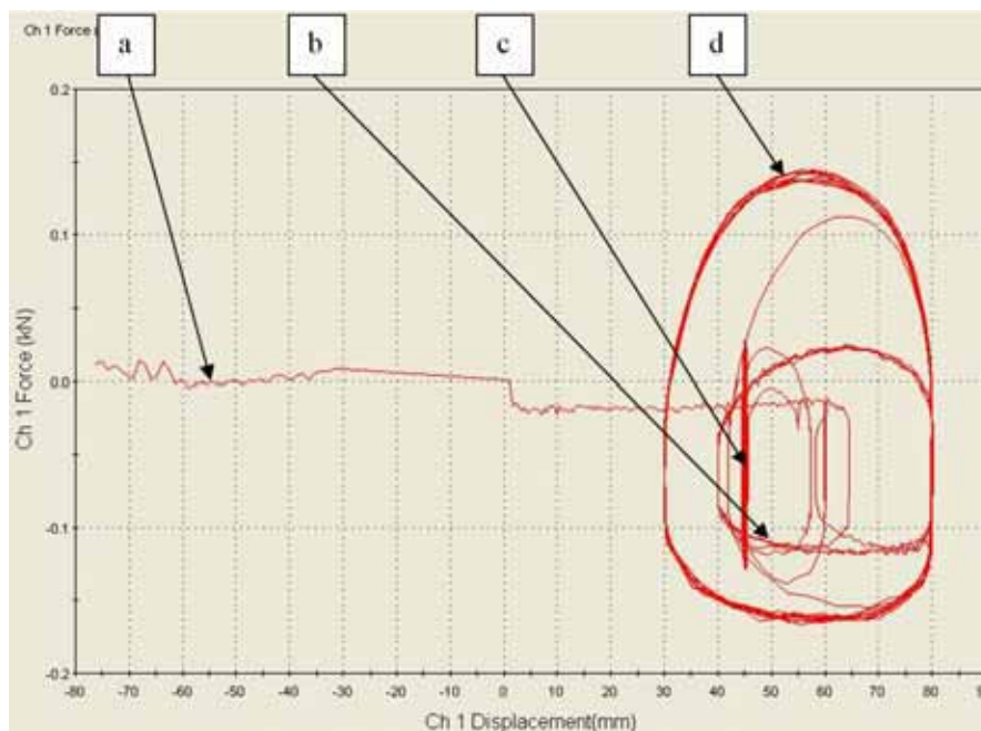
Rys 3. Zależność siły w funkcji przemieszczenia podczas badania amortyzatora
