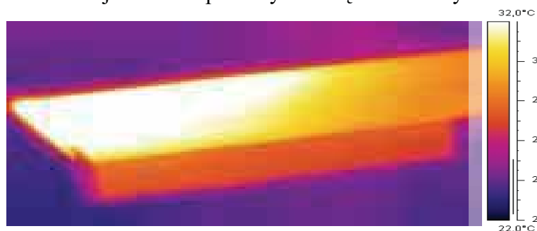
Rys.2 Rozkład temperatury na ściankach obudowy – zdjęcie z kamery termowizyjnej
