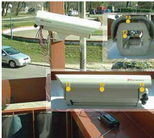
Rys.1 Symulacja pracy obudowy zewnętrznej Marathon MH-805/230 oraz rozłożenie czujników temperatury wewnątrz obudowy
