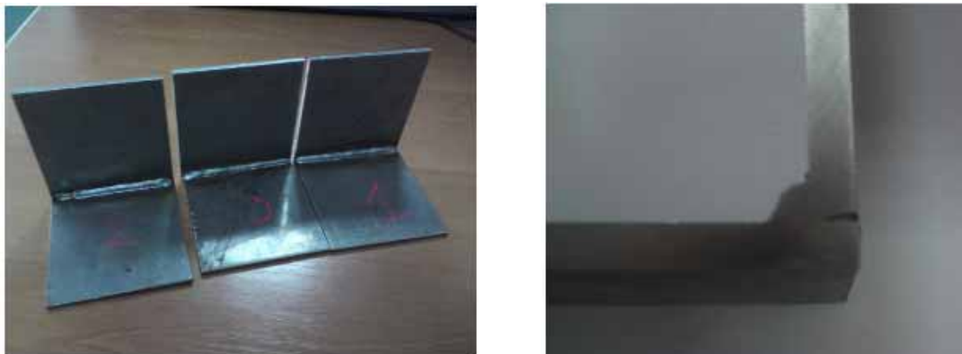
Rys. 2. Blachy po procesie spawania: a) zestawienie próbek, b) przekrój poprzeczny
