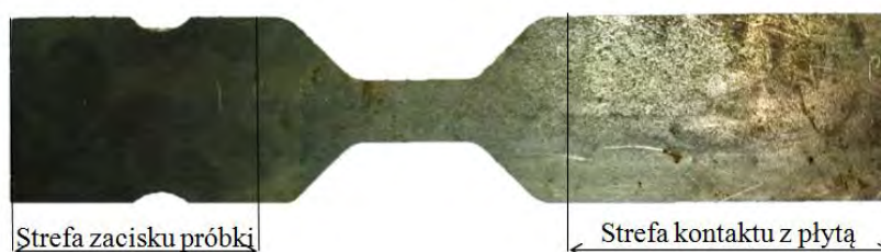
Rys. . P róbka do badań materiałowych
