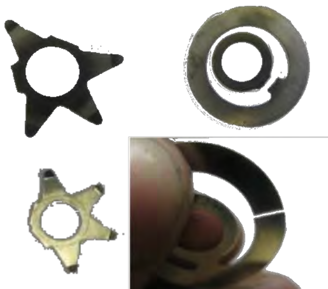
Rys. 2. Przykładowe postacie pęknięcia elementów
