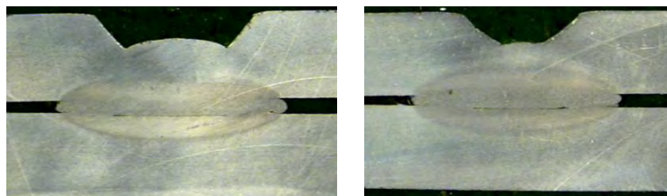
Rys. 2. Zdjęcia zgrzein pod mikroskopem dla czterech zglądów
