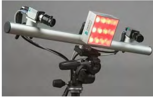
Rys. 3. System cyfrowej korelacji obrazu Dantec Q-400 [3]
