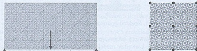
Rys.5. Optymalizowana tarcza: a) geometria z warunkami brzegowymi; b) rozmieszczenie węzłów interpolacji na połowie geometrii układu
