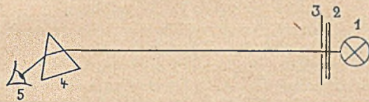
Abb. 2. 1 Mattierte Glühbirne; 2 Farbscheibe; 3 Spalt, in dunkle Pappe geschnitten; 4 Prisma; 5 Auge.
