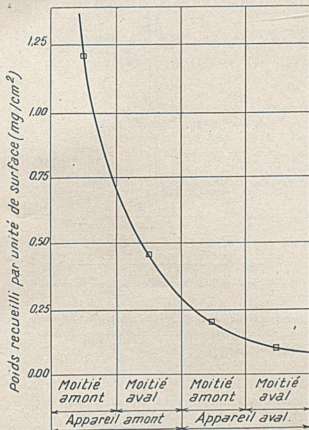
Fig. 3. - Poids des poussières recueillies en amont et en aval de chaque appareil.
