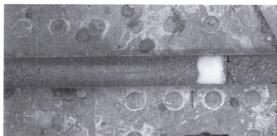
Fig. 6. The freezing sands core sample Rys. 6. Próbkę zamrożonych piasków
