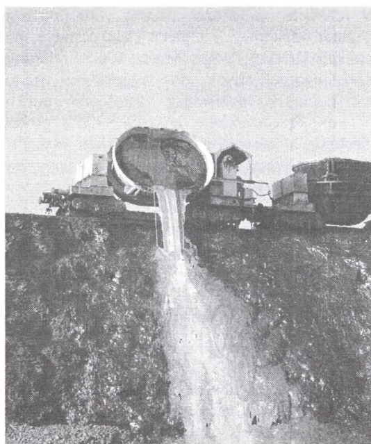
Rys. 1. Wylanie płynnego żużla szybowego
