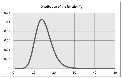
Fig. 5. Distribution of the function describing the boot end movement time T2 Rys. 5. Rozkład funkcji opisującej czas ruchu systemu ścianowego T2 Source: self-reported data.
