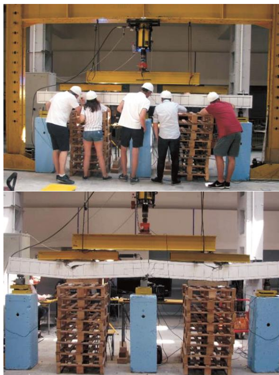
Fot. 3.16. Ćwiczenia laboratoryjne kiedyś i dziś: a) żelbetowa belka jednoprzęsłowa po zajęciach studenckich (połowa lat 80.) (fot. Arch. Pol. Śl.), b) badania wieloprzędowej belki ciągłej przez studentów w trakcie badań i po badaniach 2019 w roku (fot. R. Jasiński)
