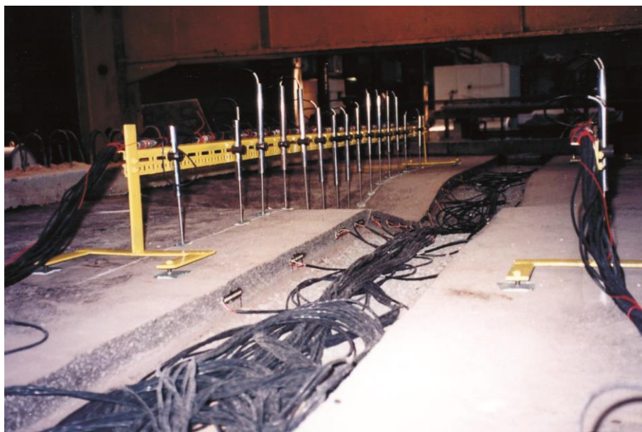
Fot. 3.34. Stanowisko do badań nawierzchni na terenach górniczych w latach 90. (fot. K. Chlipalski) Photo 3.34. Stand for testing pavement in mining areas in the 90s. (Photo K. Chlipalski)
