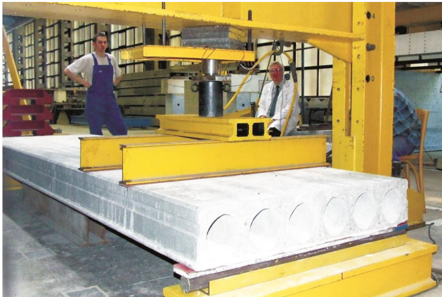
Fot. 3.28. Badania na ścinanie strunobetonowych płyt kanałowych w 2008 roku. Z prawej strony siedzi prof. dr inż. Andrzej Ajdukiewicz, z lewej strony stoi inż. Tomasz Hahn, pracownik inżynieryjno-techniczny Katedry Inżynierii Budowlanej (fot. M. Węglorz)
