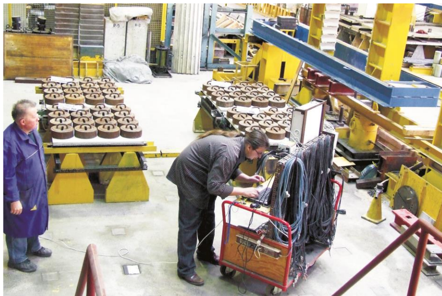
Fot. 3.29. Badania cienkich płyt zbrojonych niemetalicznymi siatkami tekstylnymi w 2009 roku. Przy aparaturze pomiarowej stoi dr inż. Bernard Kotala, z lewej strony stoi inż. Władysław Marchacz, pracownik Katedry Konstrukcji Budowlanych (fot. B. Kotala)
