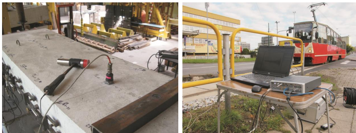
Fot. 3.20. Pomiary drgań realizowane w laboratorium dynamiki budowli: a) analiza modalna płyty w warunkach laboratoryjnych, b) pomiary drgań gruntu w terenie (fot. K. Gromysz) Photo 3.20. Vibration measurements carried out in the laboratory of building structures dynamic: a) modal analysis of panels in laboratory conditions, b) soil vibration measurements in the field (Photo K. Gromysz)
