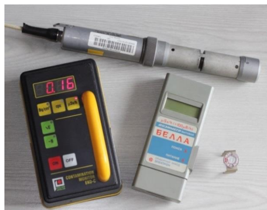
Rys. 18.1. a) Licznik URL-2, b) Liczniki Geigera-Mullera, sonda SGB-1DW z źródłem kontrolnym Fig. 18.1. a) Counter URL-2, b) Geiger-Muller counters, probe SGB-1DW with control source
