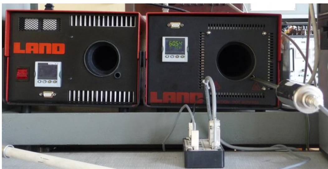
Rys. 5.1. Techniczne ciała czarne. Współczynnik emisyjności \varepsilon > 0,995
