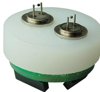
Rys. 16.3. Przykład pelistora ze zdemontowaną osłoną Fig. 16.3. Example of pellistor with removed enclosure
