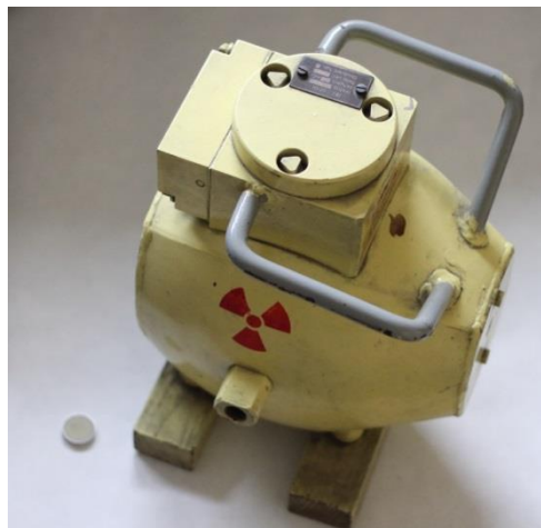
Rys. 18.1. Przemysłowy pojemnik na źródło promieniotwórcze. Po lewej stronie źródło Tl-204 wykorzystywane w trakcie ćwiczenia
