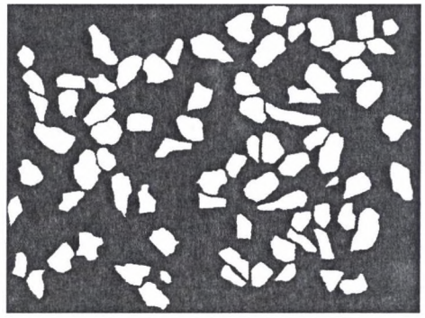
Rys. 2. Diabaz – 0,032 \div 0,04 mm: a) zdjęcie z mikroskopu skaningowego, powiększenie 200x; b) obraz binarny
