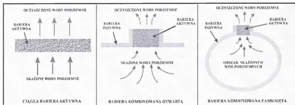
Rys. 1. Podstawowe typy barier remediacyjnych Fig. 1. Main types of PRB
