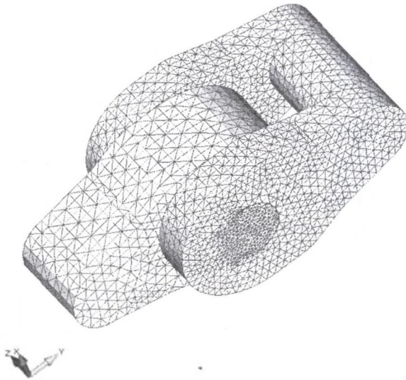
Rys. 3. Geometria i dyskretyzacja połączenia przegubowego Fig. 3. Geometry and digitizing of an articulated joint
