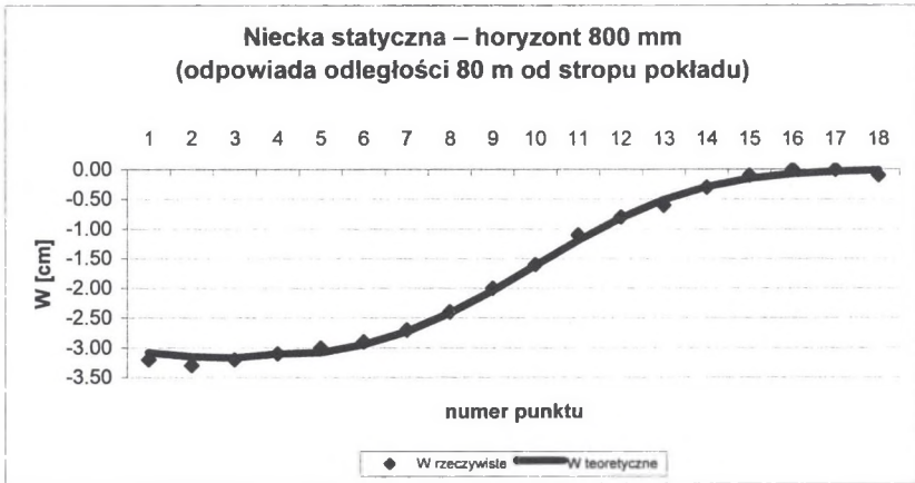
Rys. 3. Niecka statyczna na linii pomiarowej w odległości pionowej 800 mm od stropu pokładu Fig. 3. The static trough on the measurements line within the distance of 800 mm from the roof of coal bed
