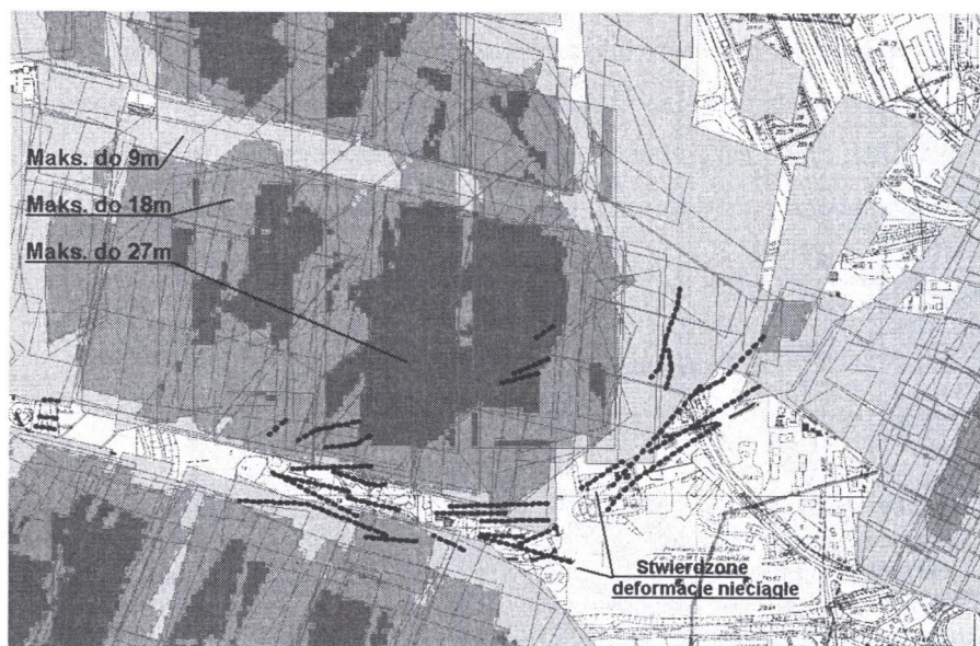
Rys. 5. Fragment mapy sumarycznej miąższości wybranego złoża i krawędzi eksploatacyjnych wraz z lokalizacją najważniejszych deformacji nieciągłych typu liniowego
