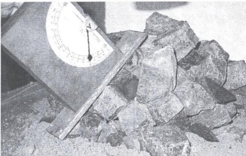
Rys. 7. Stożek usypany z dolomitu miedzionośnego o granulacji 40÷53 mm znajdujący się na warstwie piaskowca miedzionośnego o granulacji 0,1÷6 mm
