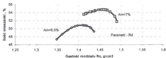
Rys. 2. Ekstremalna charakterystyka układu q_m=q_m(\rho_1,\rho_2) dla stałej zadanej zawartości popiołu a_m=6.5\% i 7\% Fig. 2. Extreme characteristic of the system q_m=q_m(\rho_1,\rho_2) for a desired ash content a_m=6.5\% and 7\%
