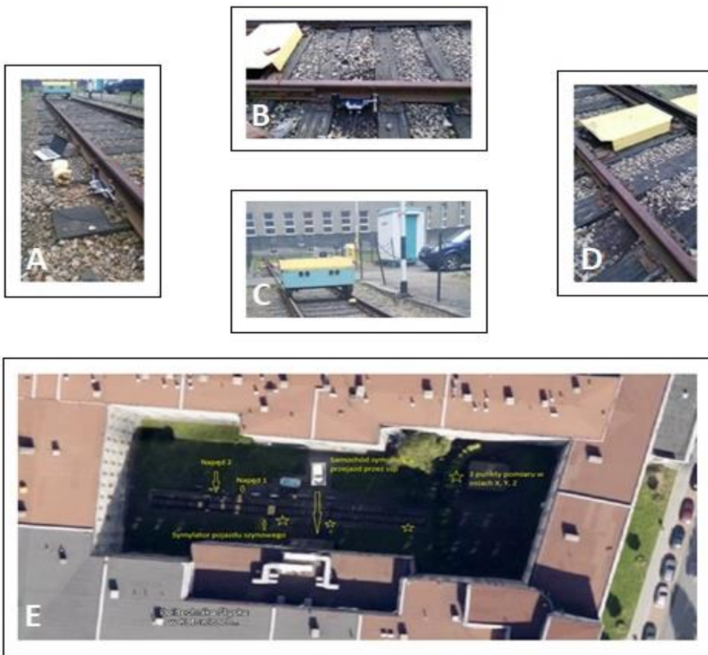
Rys. 31 Dokumentacja zdjęciowa systemu pomiarowego na terenie Politechniki Śląskiej gdzie: A – System pomiarowy, B- mocowanie z czujnikami drgań, C- symulator pociągu, D- napęd zwrotnicowy, E – Schemat toru testowego na terenie Politechniki Śląskiej w Katowicach. Źródło: opracowanie własne.
