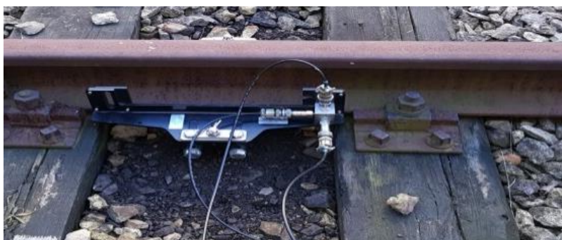
Rys. 32 Uchwyt firmy Bombardier wraz z piezoelektrycznymi czujnikami przyspieszenia.
